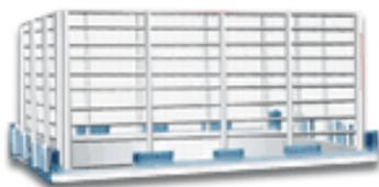
Completamente de aluminio, basado en un pallet aeronáutico de 223.5 x 317.5 cm., los lados removibles son de construcción tubular cubiertos con redes durante su transporte.
