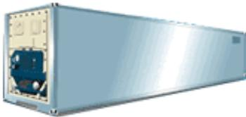
Con equipo propio de generación de frío. Diseñados para el transporte de carga que requiere temperaturas constantes sobre bajo cero. Ejemplo: carne, pescado, frutas, etc.
