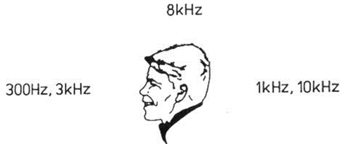
Figura 4. 20 Picos de resonancia en las HRTF corresponden a diferentes localizaciones de las fuentes sonoras en el plano medio
