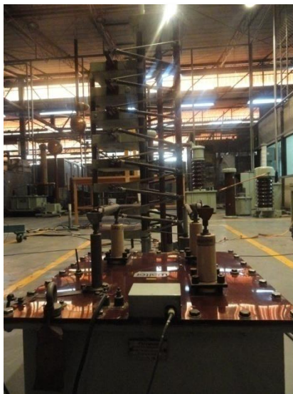
Figura 4.4 - Control de tensión en C.A y rectificación.
