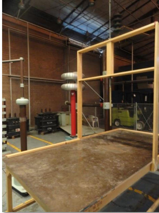
Figura 4.9 - Configuración electródica punta-plano.
