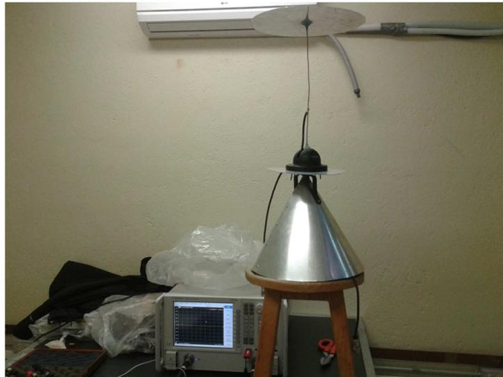
Figura 4.4. Procedimiento de medición empleando el analizador de redes vectorial Agilent N5244A.
