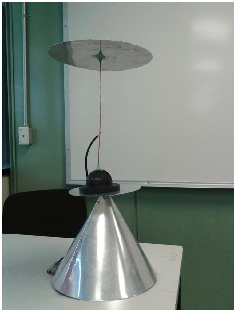
Figura 4.3. Resultado de la implementación de la antena discono.
