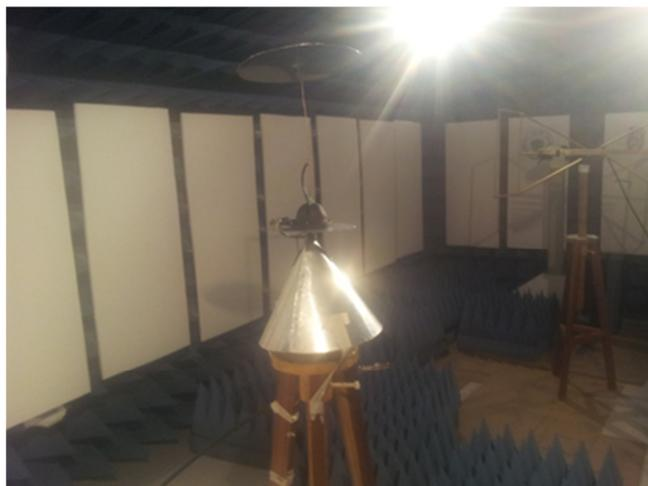
Figura 4.9. Prototipo de arreglo de antenas en la cámara semi-anechoica de la ESIME Zacatenco-IPN.
