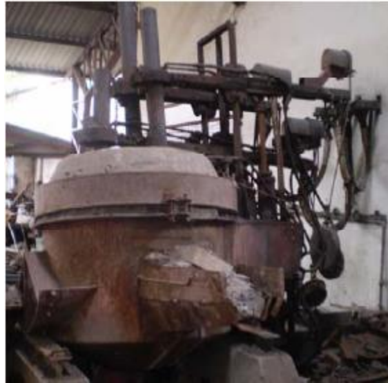
Fig. 2.1. Horno de arco de calentamiento directo
