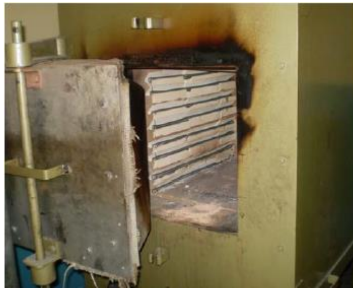
Fig. 2.3. Horno de resistencia de calentamiento indirecto
