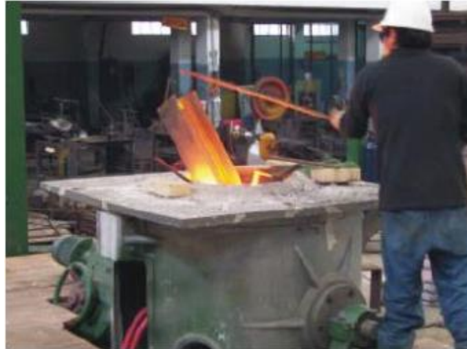
Fig. 2.4. Horno de inducción sin núcleo magnético
