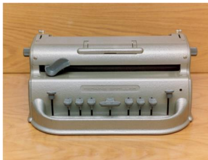
Figura 2.1.3. Máquina de Perkins para escritura Braille.
