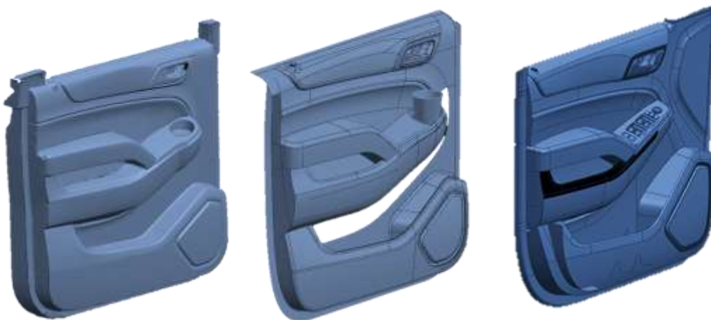
Figura 18 (A) Izquierda. Parte de arcilla escaneada, (B) Centro, Superficie clase A aproximada a la superficie escaneada, (C) Derecha, Superficie clase A con líneas completamente definidas y tema concretado
