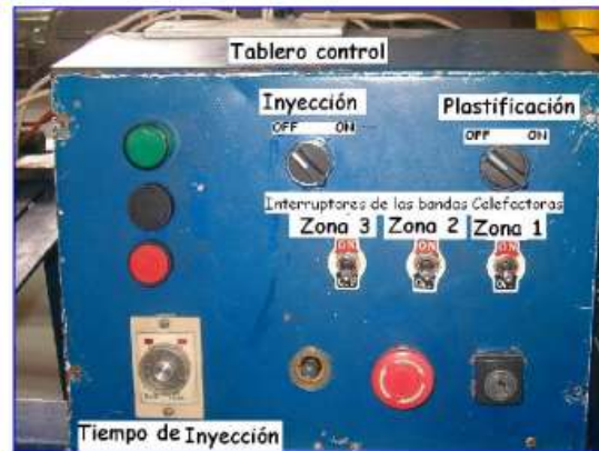
Figura 12 Tablero de control de una máquina inyectora.
