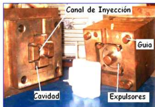
Figura 11 Partes del molde de inyección.
