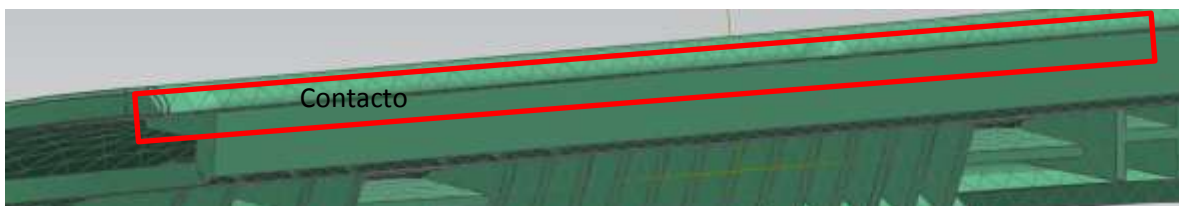
Figura 36 Restricción de contacto entre el door trim top edge y el bracket.
