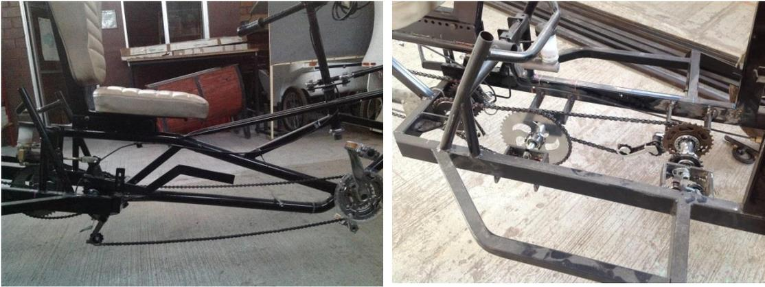
Ilustración 11.1 Sistema de transmisión modificado.
