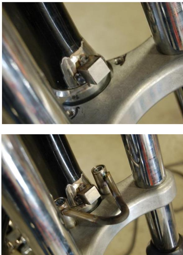
Ilustración 8.10 Montaje de Flop Stops en una motocicleta a medida.
