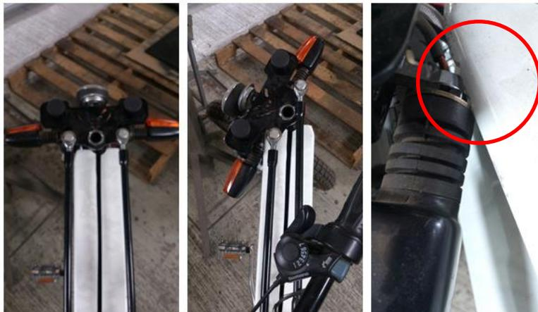
Ilustración 8.8 Efectos perjudiciales debido a la ausencia de Flop Stops en la carrocería del Cycar.
