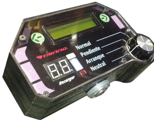
Ilustración 11.2 Prototipo del Tablero de Instrumentos.
