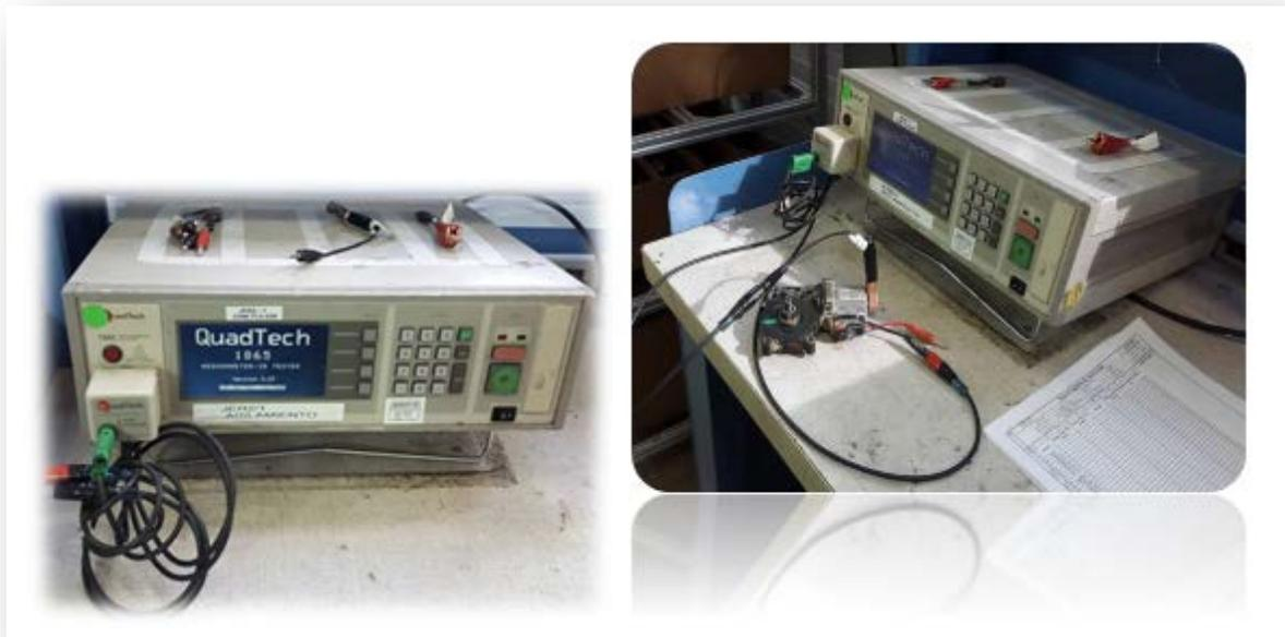
Figura 4.1 Equipo utilizado para Prueba de Resistencia de Aislamiento
