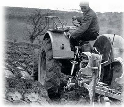
**Figura 1.14** Dispositivo Hidráulico de un Tractor
