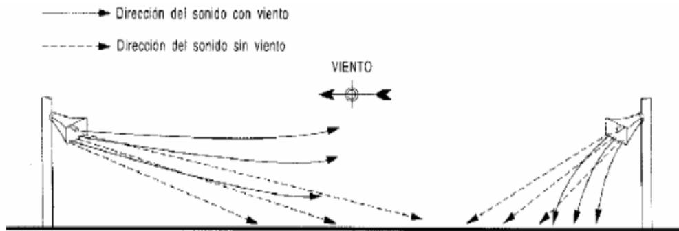
*Fig.2.1 Comportamiento del sonido provocado por el viento.*
