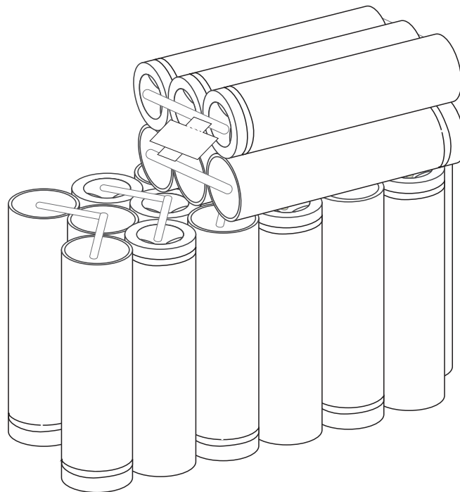
Figura 3.6. Rediseño del Arreglo de celdas.
