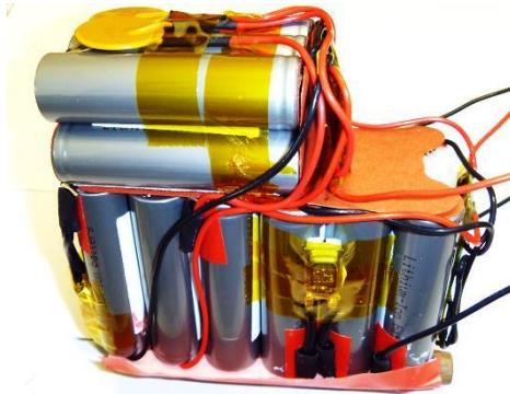
Figura 1.2. Primer arreglo de celdas recargables de ion-litio.
