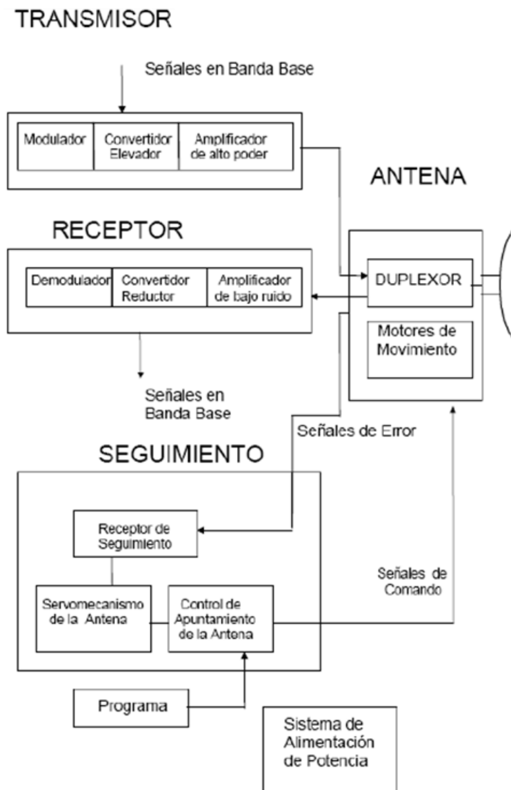
Figura 2.8. Etapas de una estación terrena.
