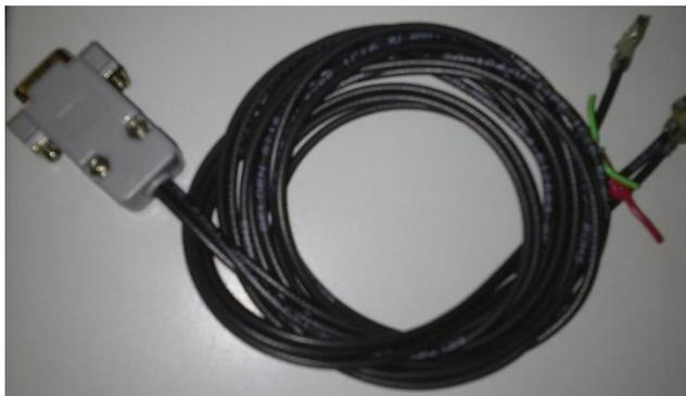
**Figura 3.40.- Cable construido para electrodos**
