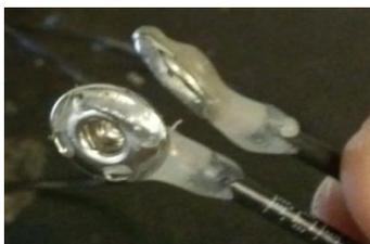
**Figura 3.39.- Broches para electrodo**
