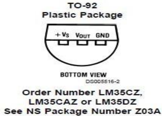
Figura 3.2 Esquema de pin-out del LM35.
