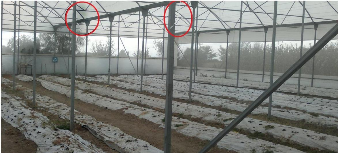
Figura 5.5. Ubicación del Termopar en la Parte Central y Delantera del Invernadero. Fuente: Elaboración propia de los autores basada en investigación de campo (Marzo, 2014).
