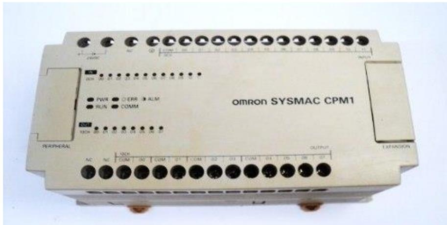
Figura 2.11.PLC. Fuente: <http://www.omronindustrial.com> (Diciembre, 2013)
