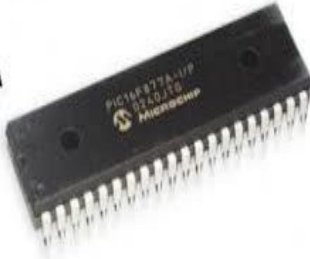
Figura 2.9. Microcontrolador PIC 16F877A. Fuente: <http://waihung.net> (Diciembre, 2013)
