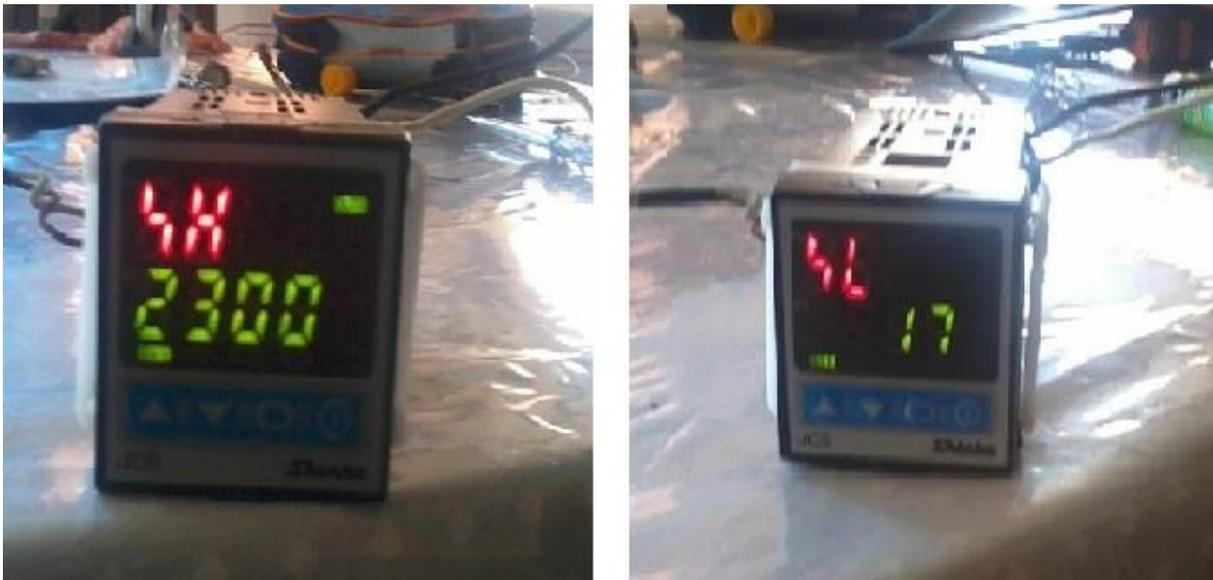
Figura 4.12. Configuración de los Límites de la Histéresis Superior e Inferior. Fuente: Elaboración propia de los autores basado en el manual de operación del controlador de temperatura - Shinko (Febrero, 2014)
