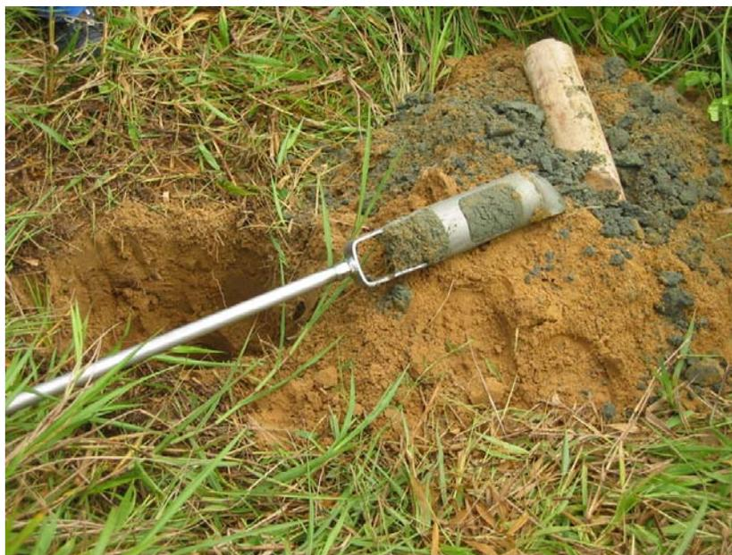
Figura VI.10 Muestreador de suelos “Hand Auger”
