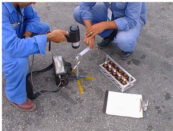
**Figura VI.8** Medición *in situ* de los COV's, donde se utiliza un analizador portátil con detector de fotoionización.
