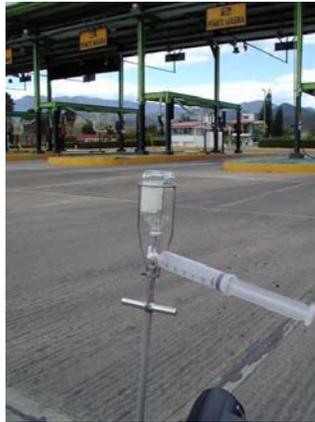
**Figura VI.6** Muestreador de gases del subsuelo.
