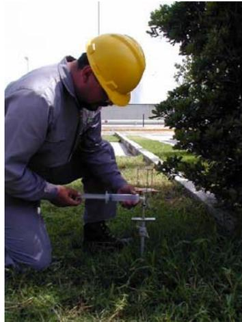
**Figura VI.7.** Toma de muestras de vapores del subsuelo.
