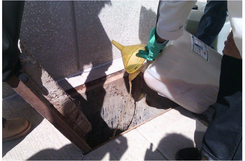
Ilustración 37. Desecho líquido de la neutralización en la coladera.
