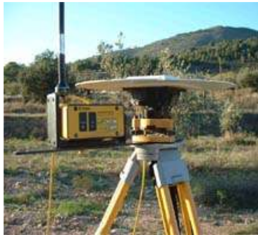
Figura 48. Imagen de un GPS cinemático (L 1), con trípode y antena.
