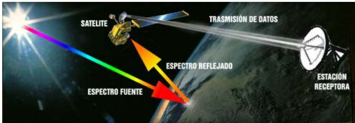
Figura 81. Componentes de un sistema de percepción remota.
