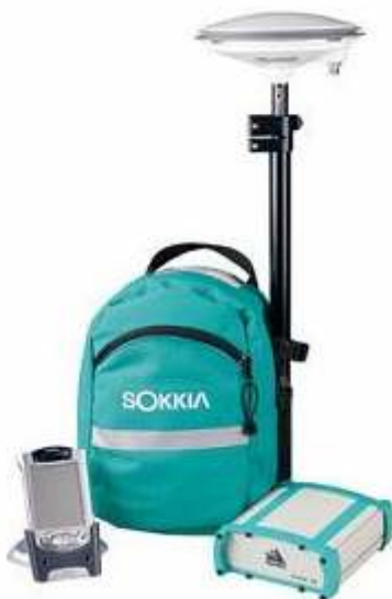
Figura 48. Imagen de un GPS cinemático (L 1), con trípode y antena.
