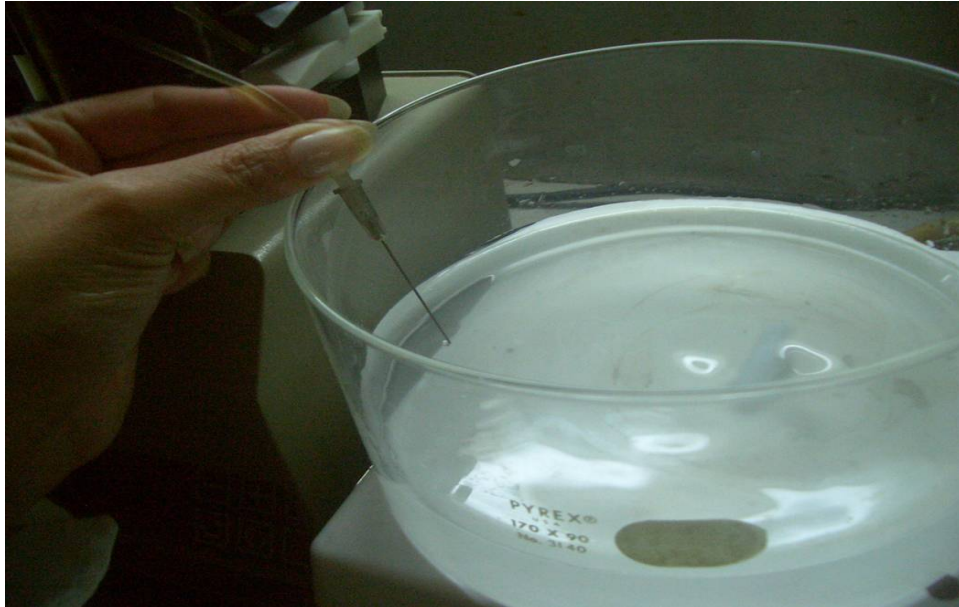
Fig. 20 En el cristalizador se encuentra la solución \text{CaCl}_2 0.3M la cual va a servir para que al contacto del alginato con los iones de calcio gelifique formando las esferas.
