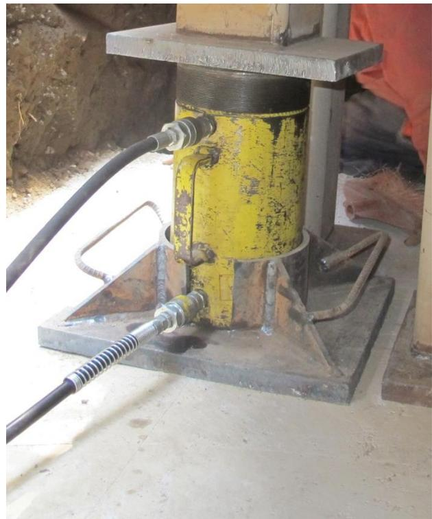
Fotografía 4.13 Mangueras de alta presión para los gatos hidráulicos de simple y doble acción
