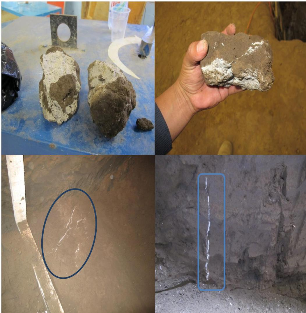
Fotografía 5.1 Inyecciones observadas en las cepas a la profundidad de 3.20 m en el eje "C-2"
