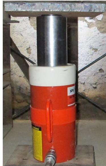
Figura 4.27 Gato hidráulico de simple acción
