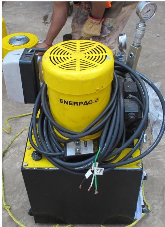
Fotografía 4.12 Bomba de control remoto ENERPAC para el manejo de los gatos hidráulicos.
