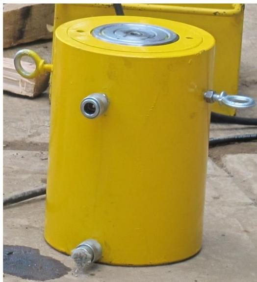
Figura 4.26 Gato hidráulico de doble acción
