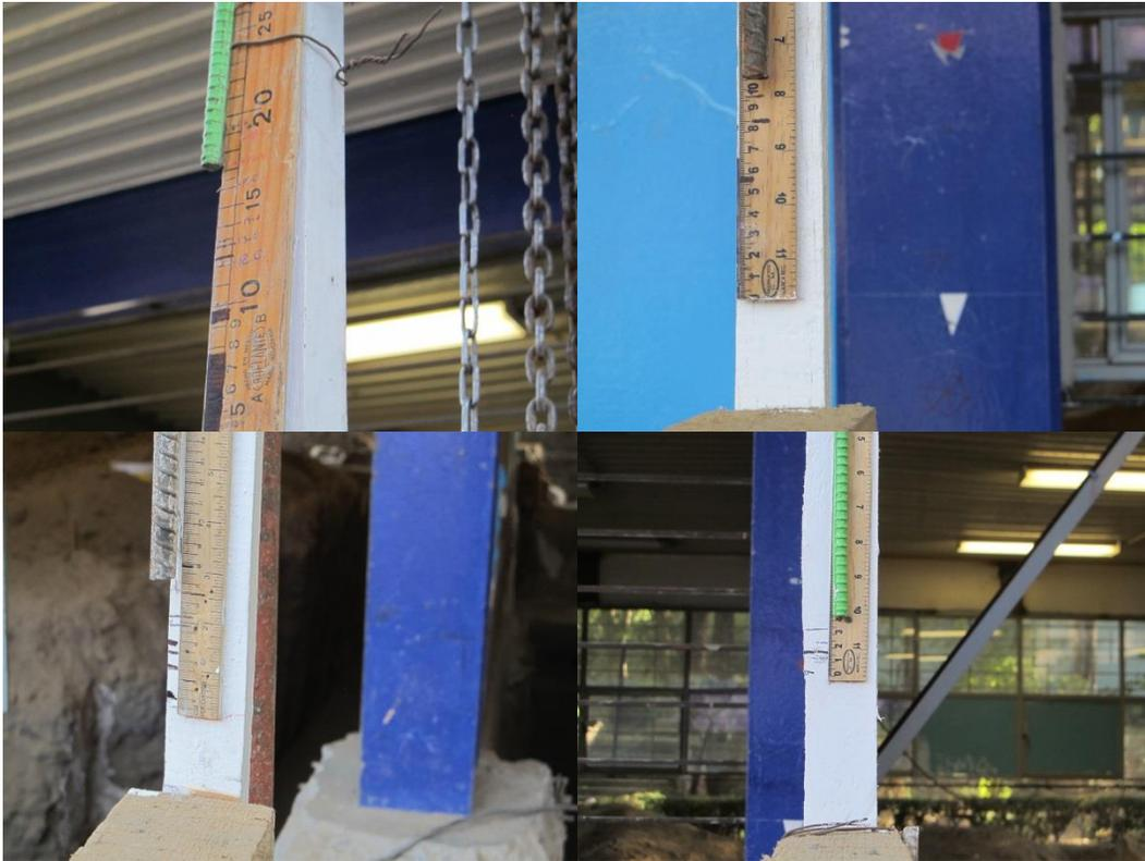
Fotografía 4.28 Se muestran los niveles obtenidos según los monitores, colocados en cada columna.
