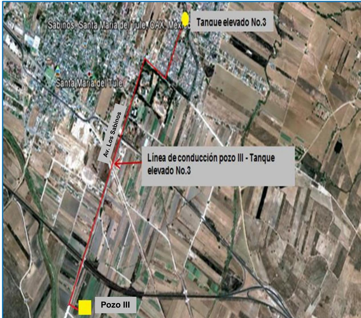
Figura III.9. Localización línea de conducción Pozo III-Tanque elevado No. 3. (Google earth, 2010).
