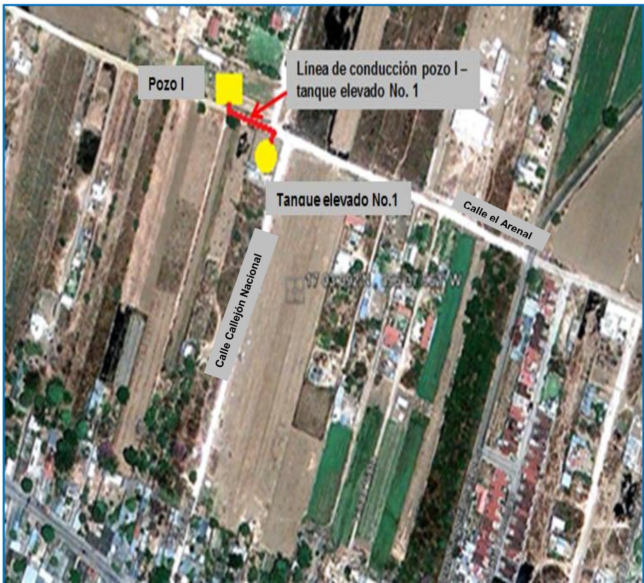
Figura III.7. Localización línea de conducción Pozo I-Tanque elevado No. 1. (Google earth, 2010).
