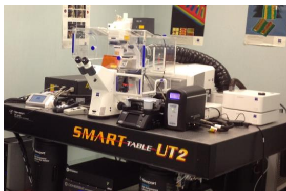
Figura 3.15. Microscopio Confocal de Barrido Laser Carl Zeiss LSM 710, (CNMN-IPN).
