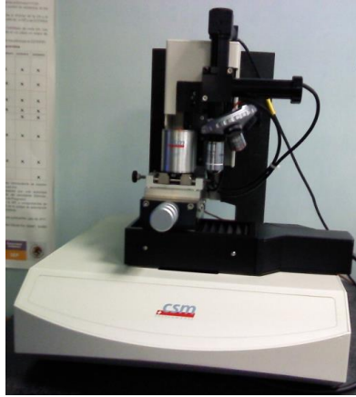
Figura 3.21. Nanoindentador TTX-NHT, CSM Instruments, (CNMN-IPN).
