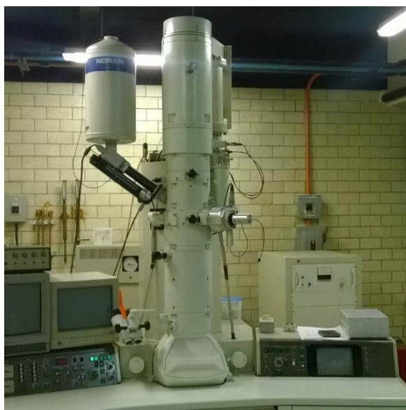
Figura 3.12. Microscopio electrónico de transmisión JEOL Modelo JEM-2000 FX II (ESIQIE-IPN).
