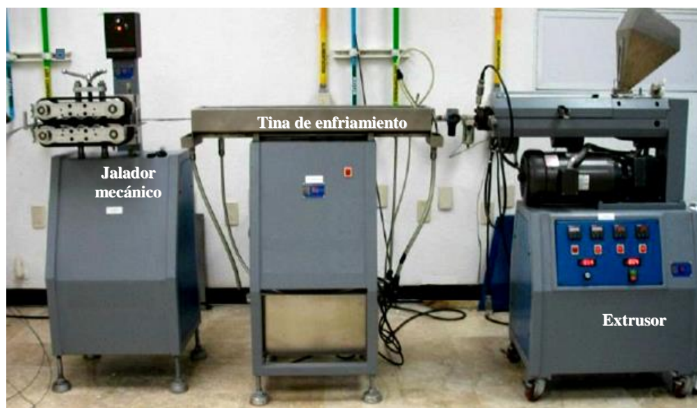
Figura 3.10. Línea de operación del proceso de extrusión (ITESM, Campus Tampico).
