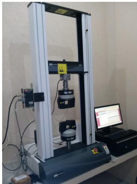
Figura 3.24. Máquina de ensayo universal INSTRON 3369 (CICATA-IPN-Unidad Altamira).
