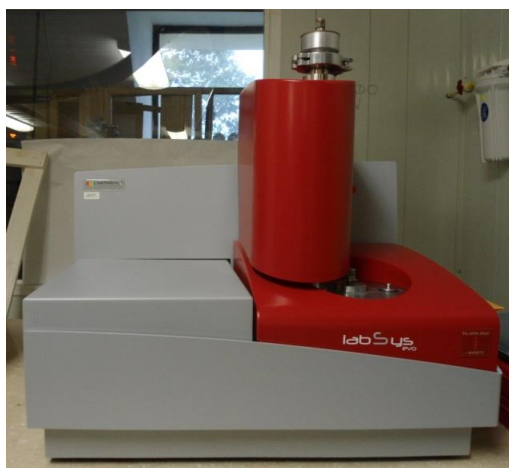
Figura 3.20. Analizador térmico simultáneo Setaram Labsys-Evo, (CICATA-IPN-Unidad Altamira).
