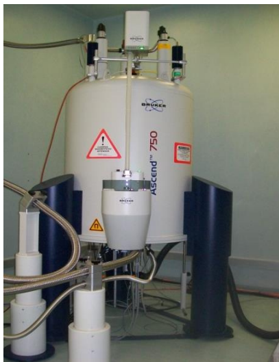
Figura 3.18. Espectrofotómetro NMR Bruker Ascend 750 MHz, (CNMN-IPN).
