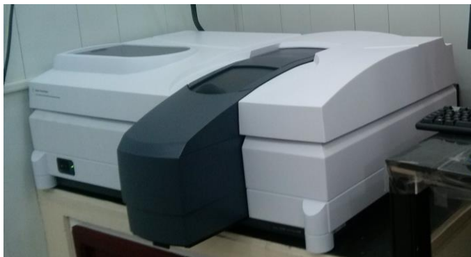
Figura 3.19. Espectrofotómetro UV-Vis-NIR Cary 5000, (CICATA-IPN-Unidad Altamira).
