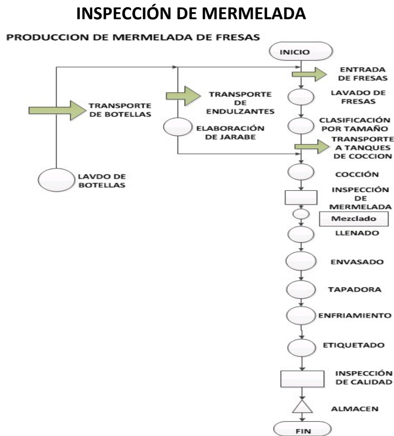
Figura 1. Producción de mermelada de Fresa. El proceso tiene como línea principal la producción de mermelada (lado derecho), donde las flechas indican el transporte o entradas de materias primas, mientras que los círculos muestran alguna operación unitaria, el rectángulo hace hincapié a análisis de calidad mientras que el triángulo es el almacén del
