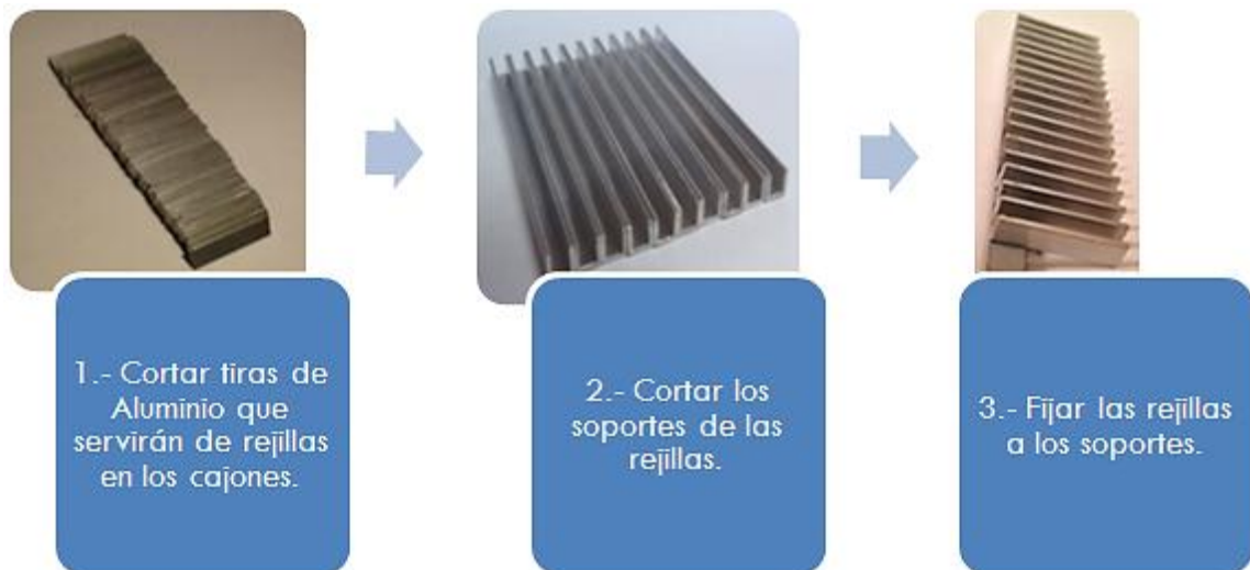
Figura III. 58 Proceso de construcción de los cajones
