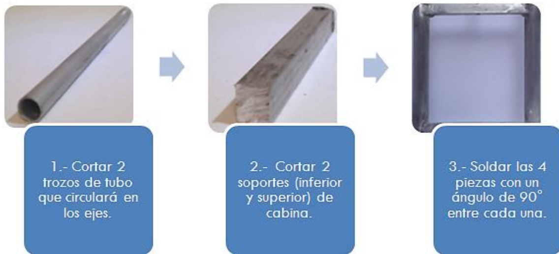
Figura III. 43 proceso de construcción de cabina
