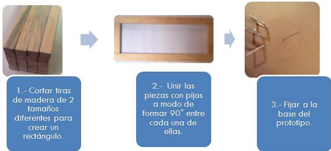
Figura III. 55 Proceso de construcción de las columnas
