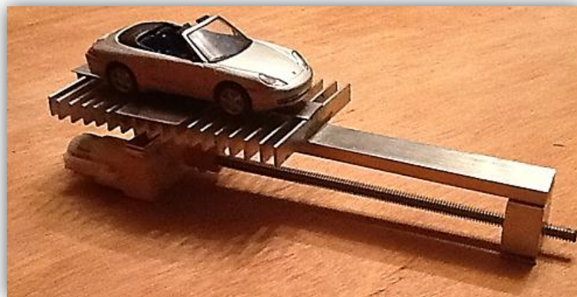
Figura III. 42 Mecanismo de plataforma móvil
