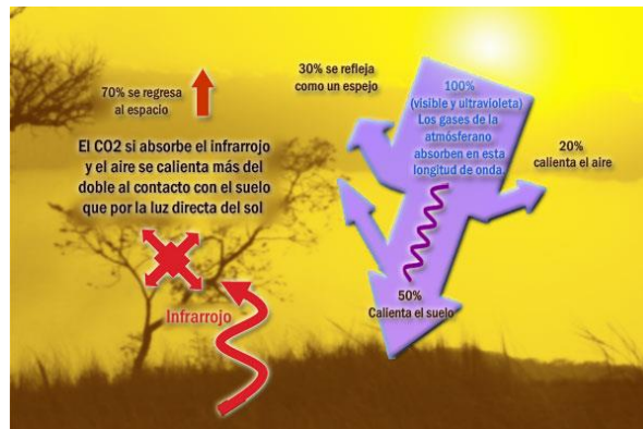
Figura 1.3. Efecto invernadero, nótese el cambio de longitud de onda entre la luz que incide en la superficie terrestre (visible y ultravioleta) y la que es reflejada por la superficie terrestre una vez que se ha calentado (infrarrojo).
