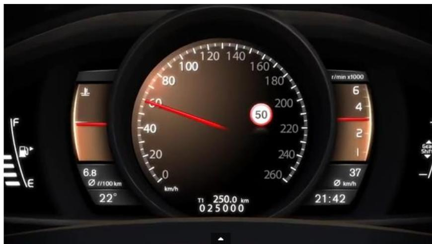
Figura 4 Sistema de información de señales de tráfico de Volvo (interior)
