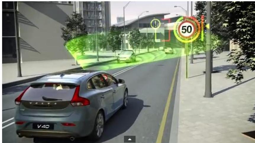
Figura 3 Sistema de información de señales de tráfico de Volvo (exterior)
