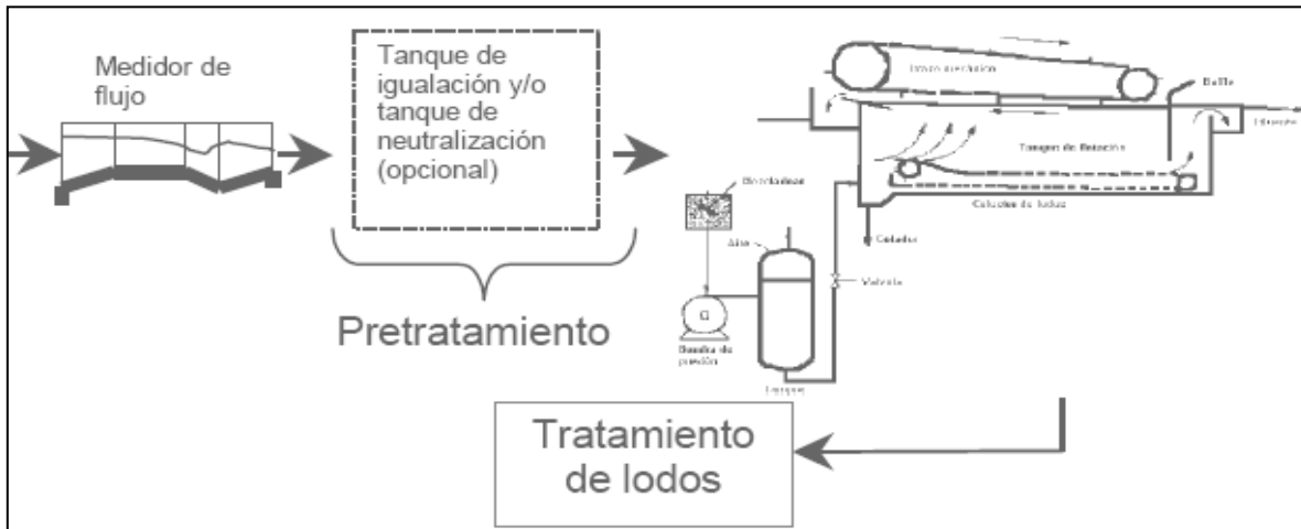
Figura 2. 24 Tren Industrial de Tratamiento Primario
