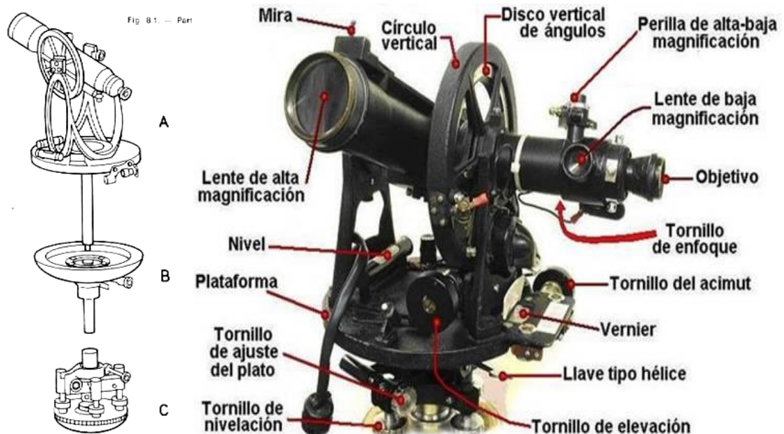
Figura 1. 3 Partes de un Teodolito
