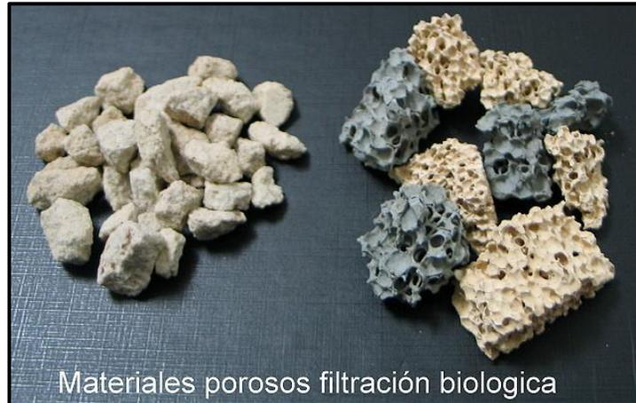
*Imagen 1.5 Materiales para la filtración biológica.*
