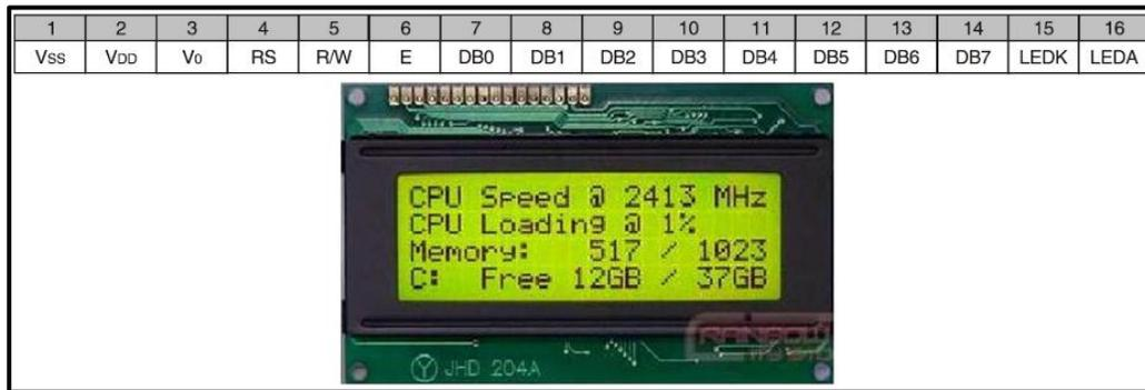
Imagen 4.9 Pantalla LCD modelo JHD 204A y configuración de los pines.
