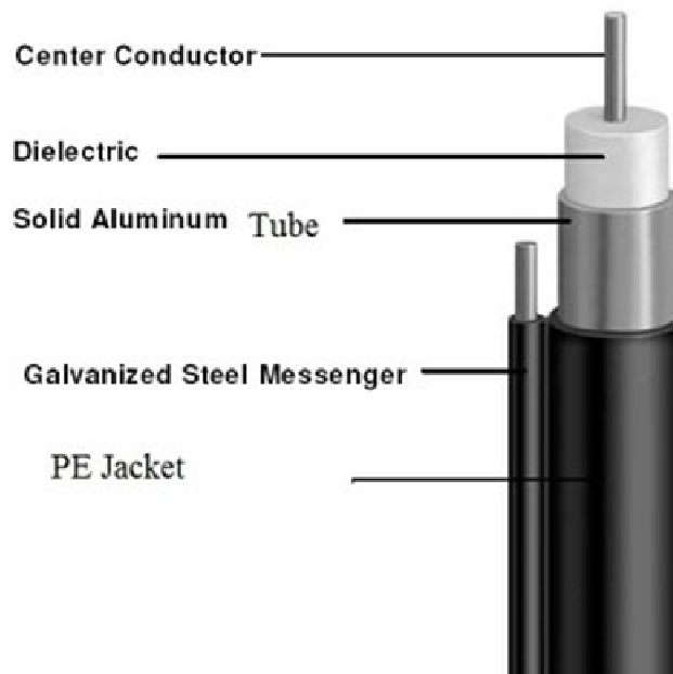
Figura 2.7. Componentes del cable coaxial.
