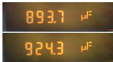
Figura 4.18 Capacitor 1000\mu\text{F} medido con el equipo WK
