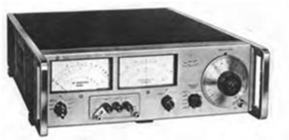
Figura 1.11 Medidor de impedancia vectorial Marca BRC/HP Tipo 4800 Fabricado en 1955.
