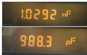
Figura 4.20 Capacitor 1\text{nF} con el medidor WK
