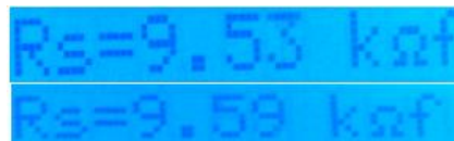
Figura 4.13 Resistencia de 10 k \Omega con el medidor RLC
