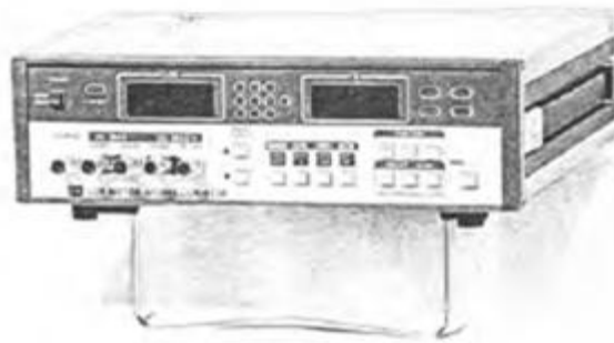
Figura 1.23 Medidor LCR Marca Goodwill Modelo 851B Fabricado en 1955
