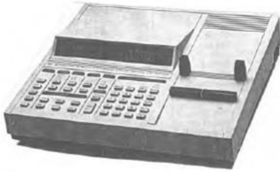
Figura 1.21 Medidor LCR Marca Stanford Res. Modelo 715 Fabricado en 1991
