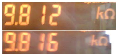
Figura 4.12 Resistencia 10k \Omega con el medidor WK.
