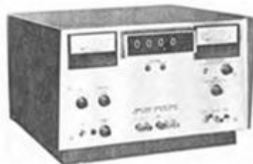
Figura 1.14 Probador de capacitancia Marca Micro Instr. Modelo 5300A Fabricado en 1965
