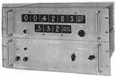
Figura 1.13 Medidor de Capacitancia Digital Marca Electro-Instruments Modelo CD Fabricado en 1960
