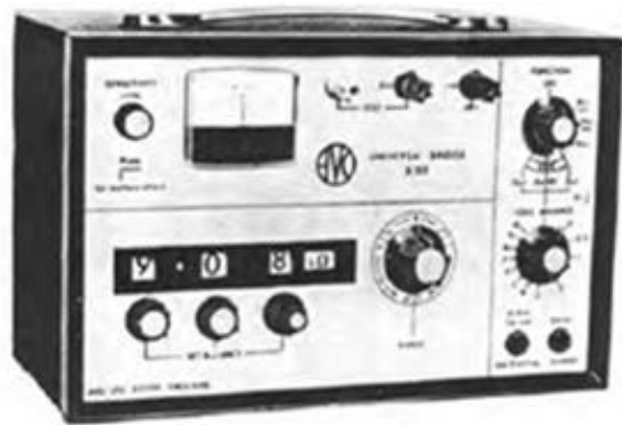
Figura 1.5 Puente universal Marca AVO Tipo B 150 Fabricado en 1968
