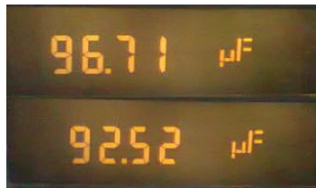
Figura 4.16 Capacitor de 100\mu\text{F} WK
