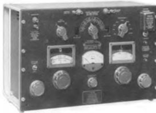
Figura 1.12 Puente de inductancia incremental Marca GR Tipo 1633 Fabricado en 1962
