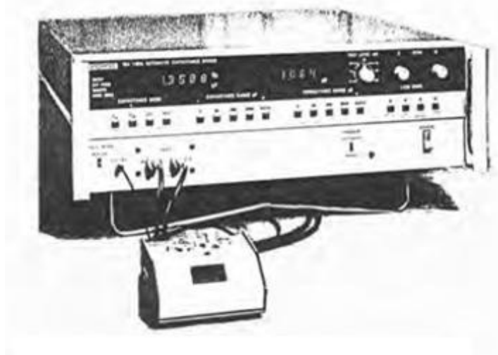
Figura 1.18 Puente Automático de Capacitancia de 1MHz Marca BEC Modelo 76A Fabricado en 1976
