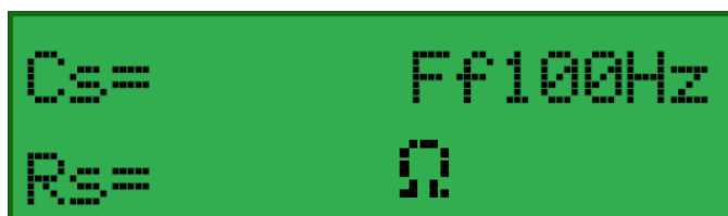
Figura 3.16 Pantalla secundaria en modo capacitancia en serie y frecuencia a 100Hz.
