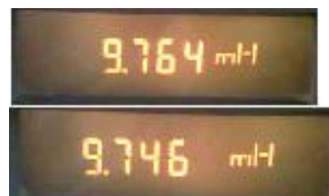
Figura 4.22 Resultados de la medición de una bobina de 10\text{mH} con el medidor WK
