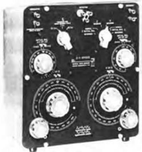
Figura 1.9 Puente Z-Y Modelo GR Tipo 1603-A Fabricado en 1955
