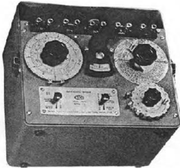
Figura 1.3 Puente de impedancias marca ESI Tipo 250 Fabricado en 1949
