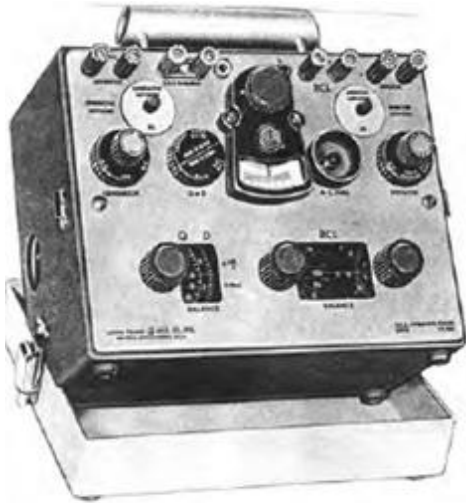
Figura 1.6 Puente de impedancia Marca Fluke Tipo 710A Fabricado en 1962
