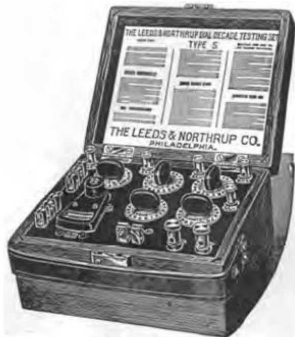
Figura 1.1 Puente de Wheatstone, arca L&N Tipo S Fabricado en 1915
