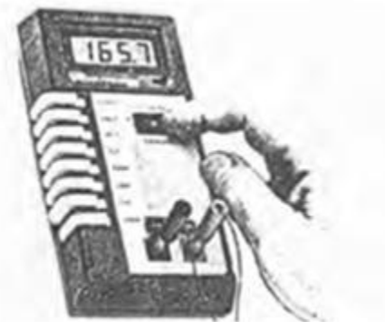
Figura 1.17 Medidor de Capacitancia Portatil Marca Data Precision 938 Fabricado en 1979
