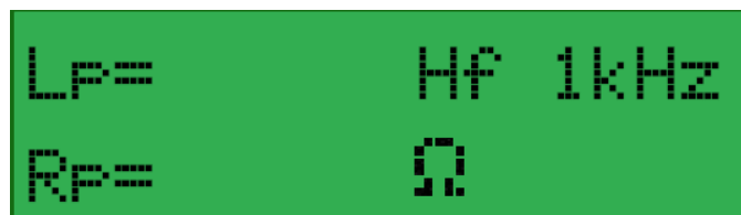
Figura 3.17 Pantalla secundaria en modo Inductancia en paralelo y frecuencia 1Khz.
