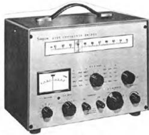
Figura 1.7 Puente de impedancia Marca Simposon Modelo 2785 Fabricado 1968
