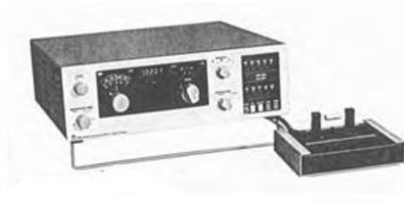
Figura 1.16 Medidor de Impedancia Digital Marca GR Tipo 1685-A Fabricado en 1973
