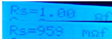
Figura 4.11 Resistencia 1 \Omega con el medidor RLC.
