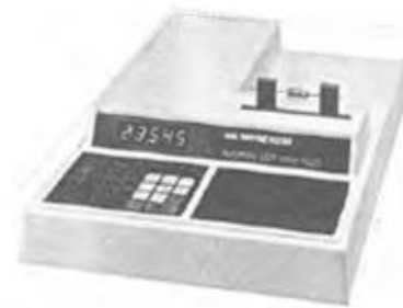
Figura 1.22 Medidor LCR Automatico Marca W-K modelo 4225 Fabricado en 1984
