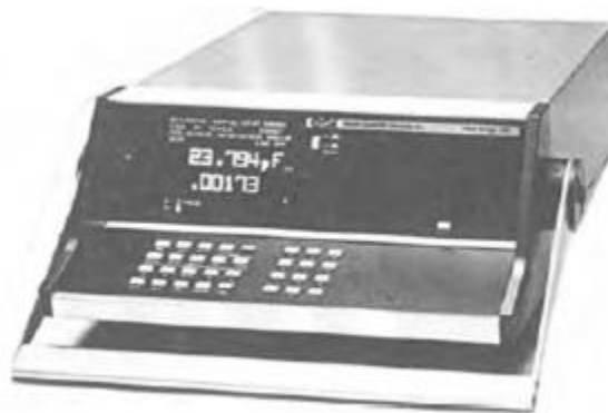
Figura 1.20 Video Bridge Marca ESI Modelo 2100 Fabricado en 1981
