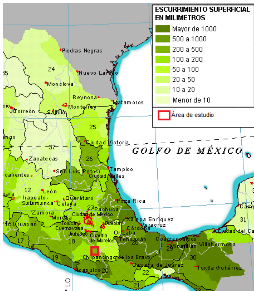
Fig. 2.7. Carta de Esgurrimento Superficial. Modificado de INEGI.
