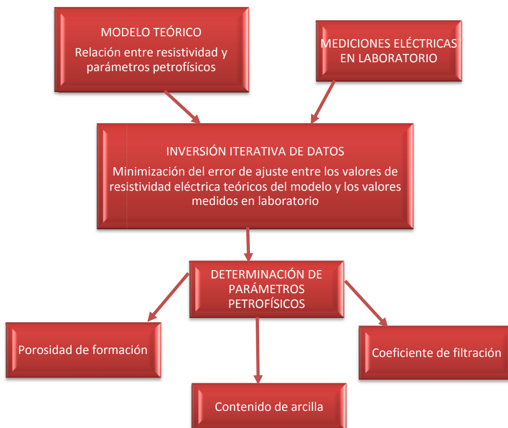
Figura 3.13. Diagrama de la metodología para la determinación de los parámetros petrofísicos del suelo.
