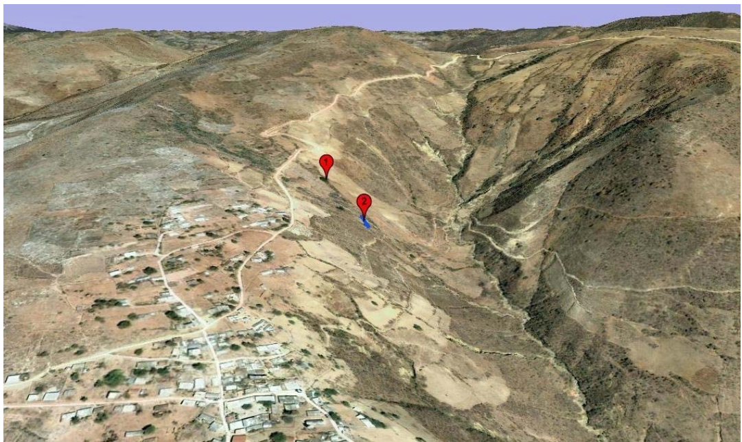
Figura 4.5. a) Se muestra el tendido sísmico y los SEV en un modelo 3D generado con Global Mapper, con proyección Nad27 (México). b) Se muestra el tendido sísmico (azul) y los SEV (1 y 2) en imágenes satelitales, fuente Google Earth.
