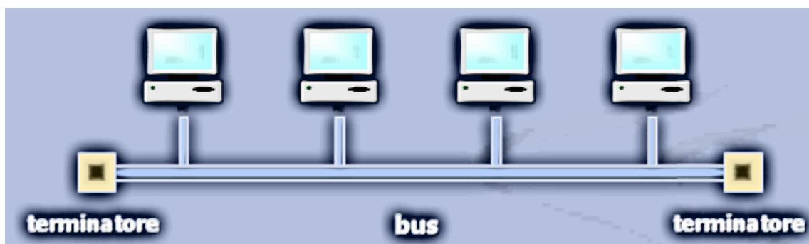
Figura 1.2. Muestra la topología de un bus lineal
