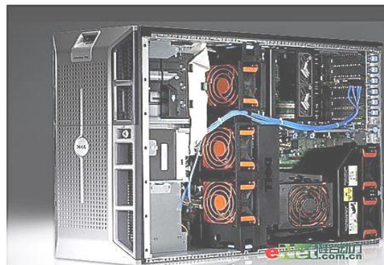
Figura 5.11 Servidores Poweredge 1900 por dentro
