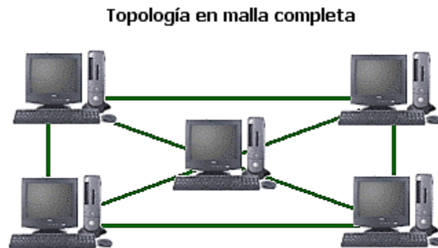
Figura 1.4 Muestra la topología malla completa
