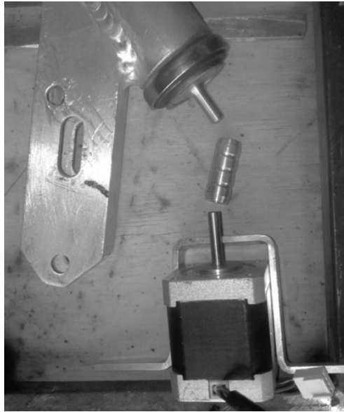
FIGURA 3.32.- ACOPLAMIENTO DE LOS TRES FACTORES: PIÑÓN, ACOPLADOR Y FLECHA DEL MOTOR A PASOS.
