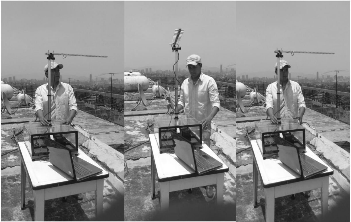
FIGURA4.8.- MONITOREO DEL ESPECTRO DE FRECUENCIA CON EL DISEÑO DE UN SISTEMA DE ROTACIÓN PROGRAMABLE PARA EQUIPOS DE ESCANEO DE TECNOLOGÍAS DE GSM Y 3G.
