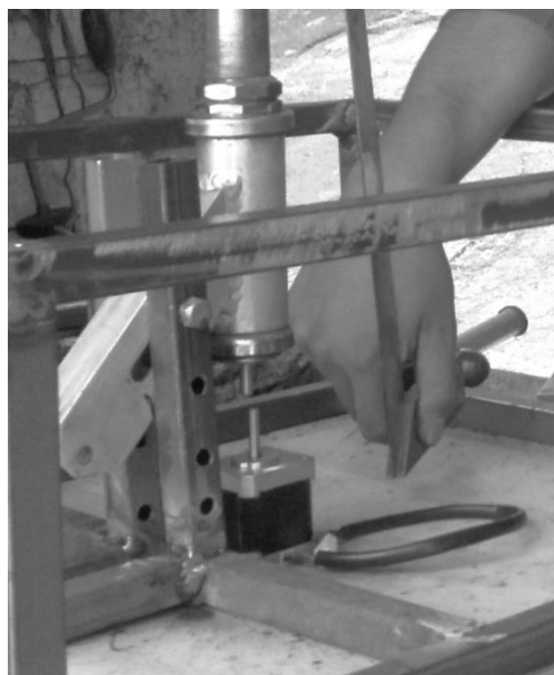
FIGURA 3.31.- INSERCIÓN DEL PIÑÓN EN EL SOPORTE DE ALUMINIO.
