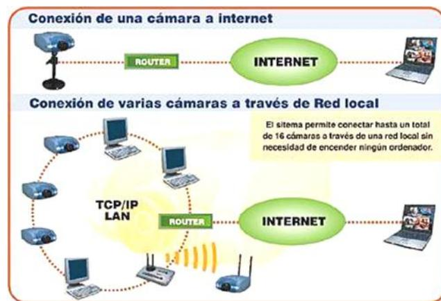
Figura 7.1 Conexión de una Cámara e Internet
