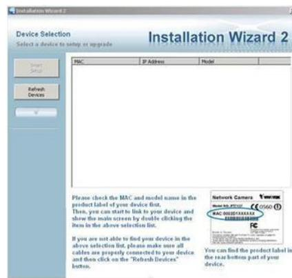
**Figura 7.8.3 Obtención de la Dirección IP Dinámica en la Cámara IP**
