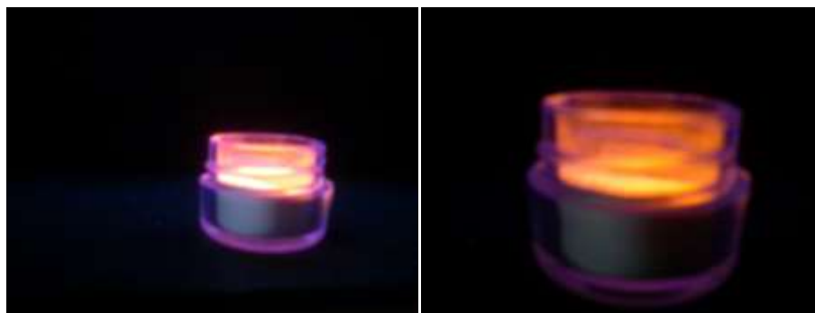
Figura x. prueba de intensidad con longitud de onda 254nm, para polvo sin tratamiento.
