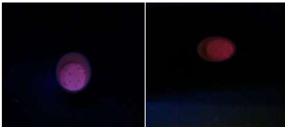
Figura x. prueba de intensidad con longitud de onda 254nm, para polvo sin tratamiento.
