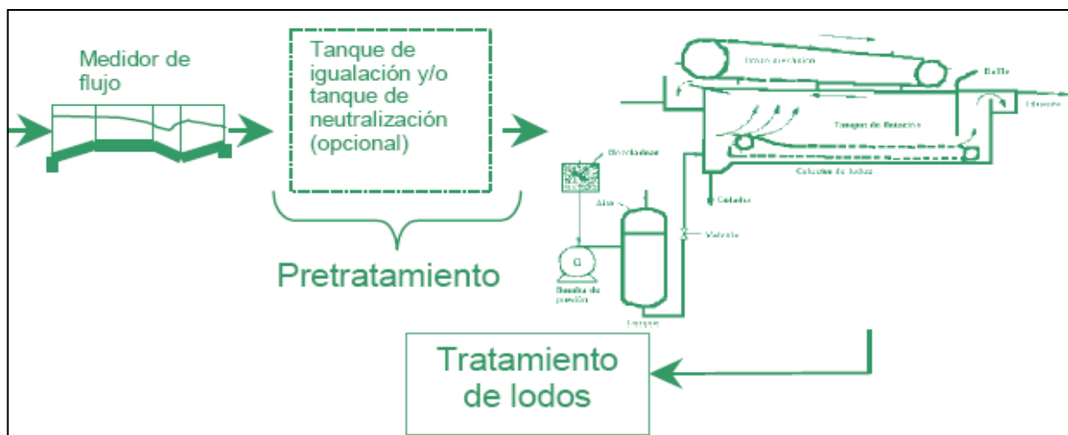
Figura 2. 25 Tren Industrial de Tratamiento Primario
