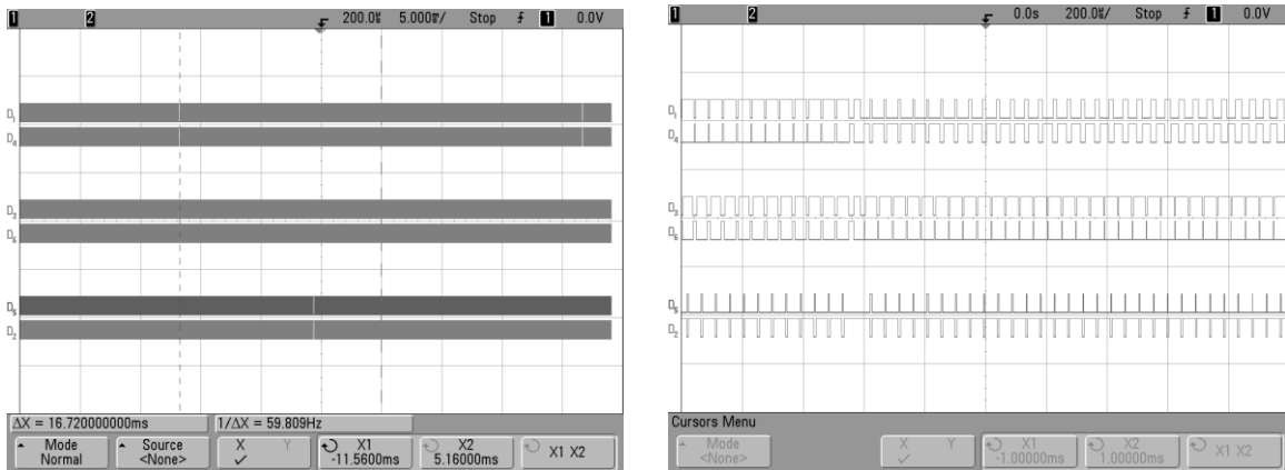
Figura 5.5.1 a) Señales de control mostrando su frecuencia fundamental de 60 Hz b) Ampliación en tiempo de las señales de control.
