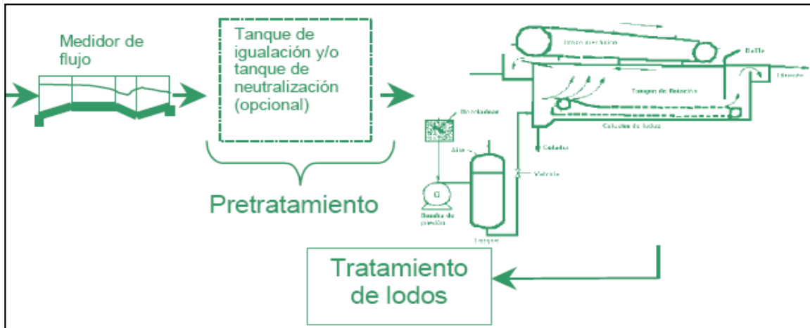
Figura 2. 24 Tren Industrial de Tratamiento Primario
