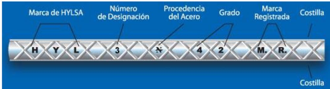
**Soldabilidad** Es importante mencionar que la varilla HYLSA es soldable sin afectar sus características físicas y mecánicas aplicando el procedimiento **COD AWS D 1.4** (Structural Code Reinforcing Steel).
