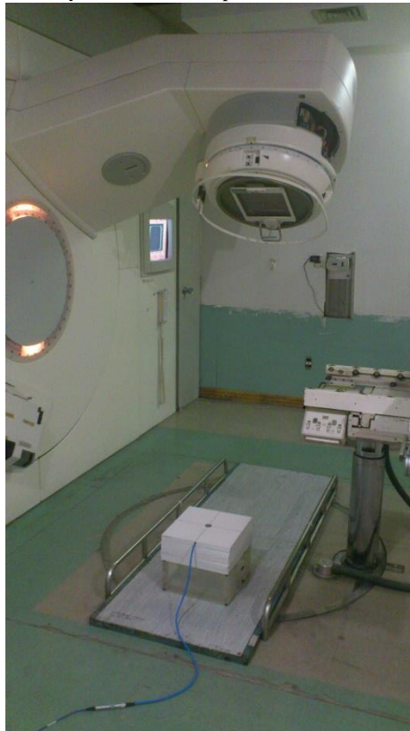
Figura. 4.10. Diseño del experimento para la obtención del aplanado de los haces duales, donde se muestra la inclinación del gantry con el ángulo determinado, la cámara de ionización dentro del fantoma de láminas.
