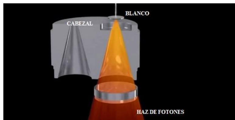
Figura 3.16. Esquema del cabezal en la producción de rayos X de un Acelerador Lineal Elekta Synergi.
