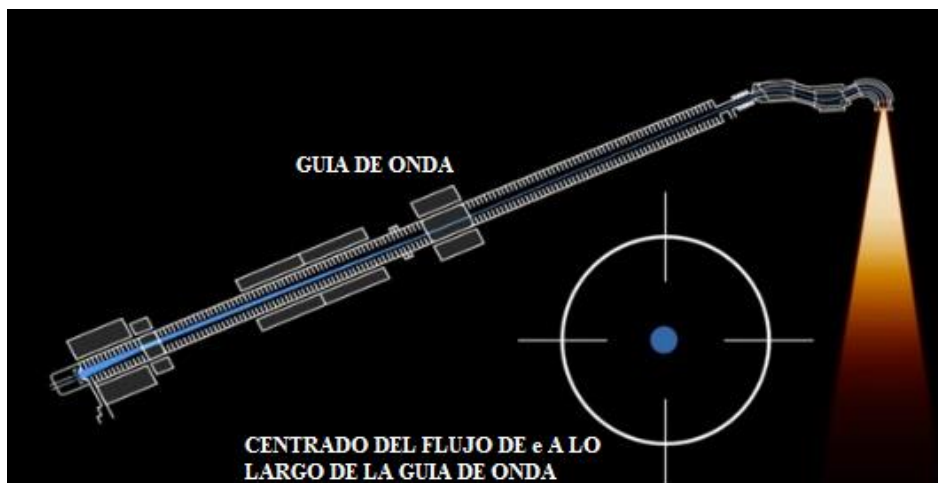
Figura 3.14. Esquema de la guía de ondas de un Acelerador Lineal Elekta Synergi.
