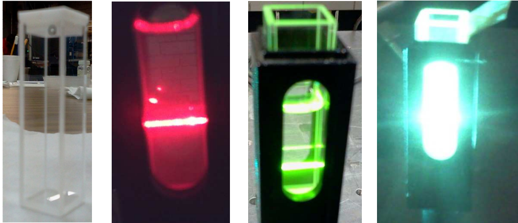
Figura 3.9 Cubeta de cuarzo en el orden siguiente: sin muestra, con muestra y laser de prueba incidiendo, con el láser de excitación a baja potencia y muestra semitransparente de Rodamina y con el láser de excitación a mayor potencia y muestra semitransparente.
