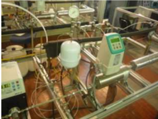
Figura 2.11 Sistema para el estudio de refrigerantes en tiempo real.
