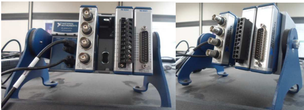
Figura 3.7 Tarjeta NI cDAQ-9174 con el modulo NI 9215 (entradas de señal analógica) y NI 9401 (salida digital).
