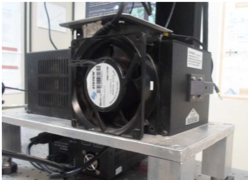
Figura 3.1 laser de Argón usado para excitación de las muestras.
