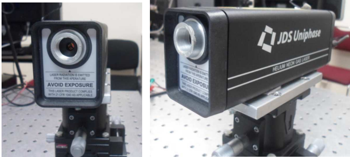
Figura 3.2 Laser de He-Ne (prueba), empelado para sondear la región muy próxima de excitación
