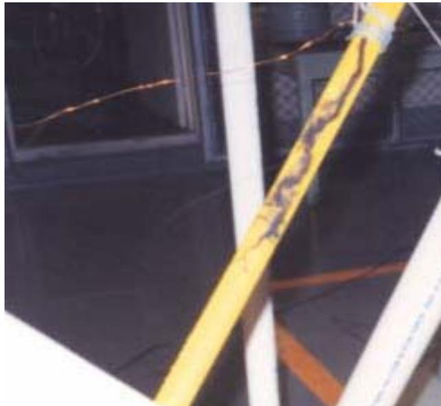
**Figura 4.4** *Tracking* sobre una pértiga dieléctrica fallada
