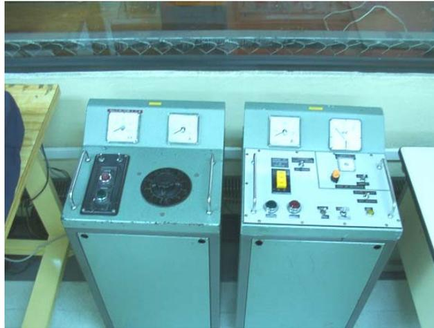
**Figura 2.2** Consola de control de la fuente de CA
