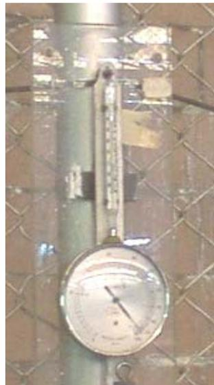
**Figura 2.6** Polímetro empleado para la medición de la humedad relativa y la temperatura del aire
