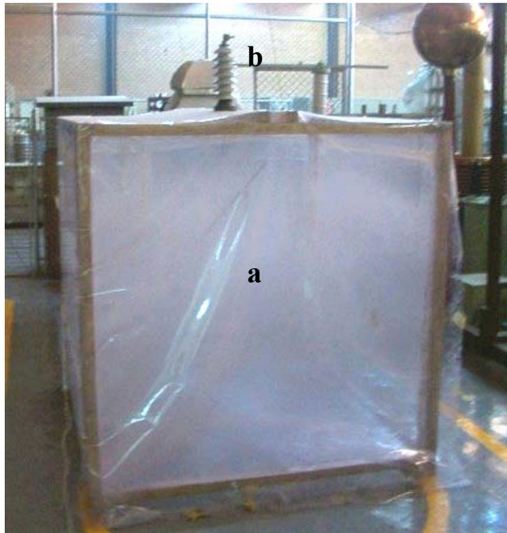
**Figura 2.4** a) Cámara de niebla limpia, b) Boquilla
