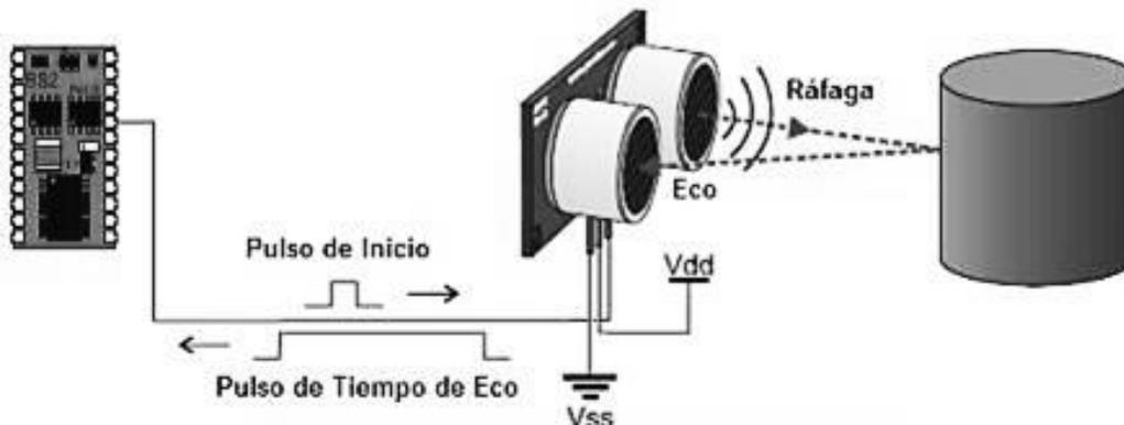
Figura 2.4. Funcionamiento del sensor HC-RS04.
