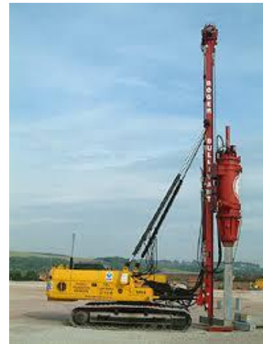
Fig. 36 Martillos para Hincado de pilotes. Google.
