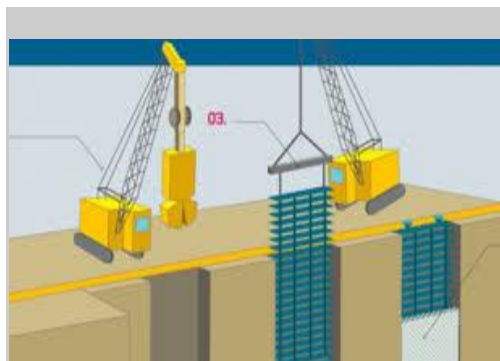
Fig. 56 Proceso constructivo de muro milán. www.Maquinariacimentaciones.wordpress.com
