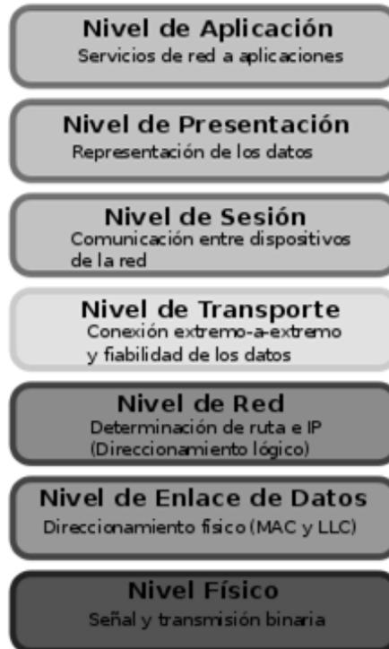
Figura 1.5 Capas del modelo OSI
