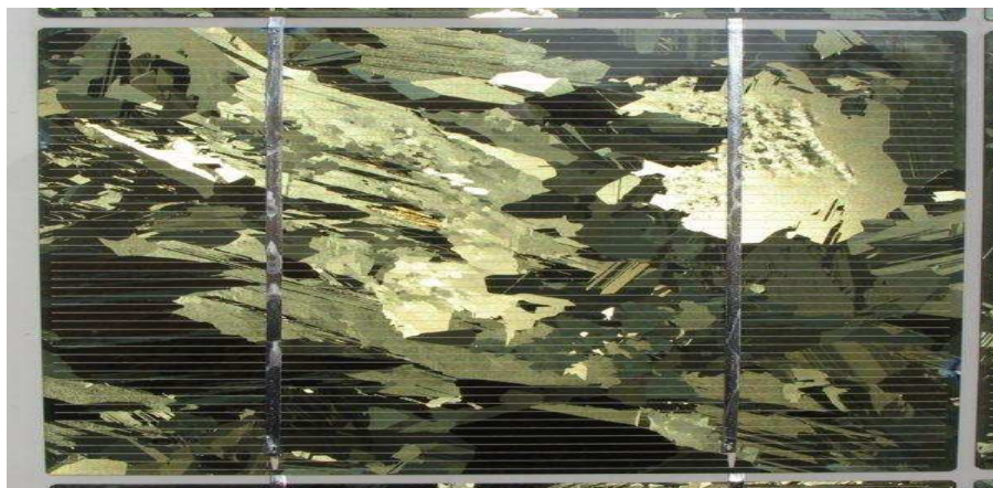
Figura 1.6 Celdas policristalinas de Silicio
