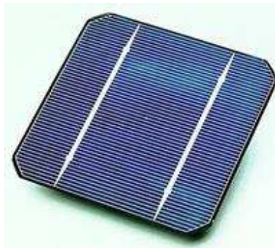
Figura 1.5 Celdas mono cristalinas de Silicio
