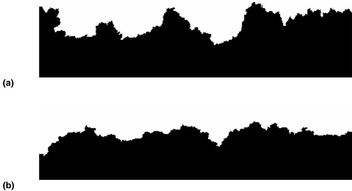
Figura V-13. Interfases formadas en papel filtro. a) dirección longitudinal, b) dirección transversal.
