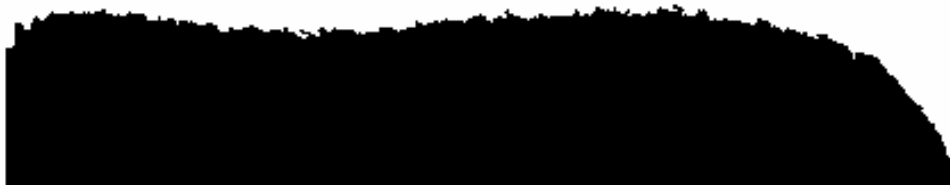
Figura V-10. Interfase formada en un experimento de quemado en una probeta de papel secante (dirección longitudinal), W = 24 mm.
