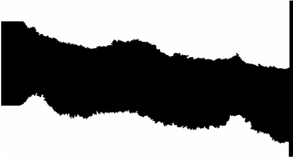
Figura V-9. Interfase formada en un experimento de fractura en una probeta de papel secante (dirección longitudinal), W = 24 mm.
