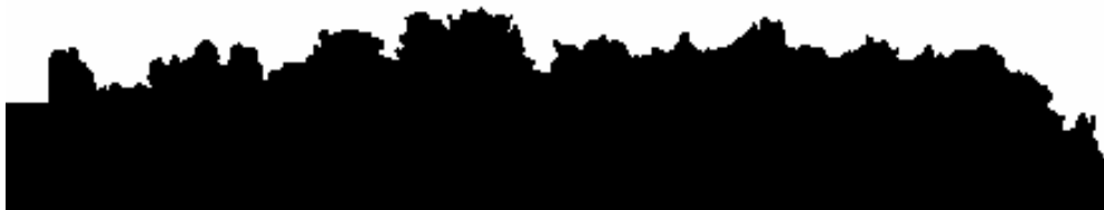
Figura V-11. Interfase formada en un experimento de quemado en una probeta de papel secante (dirección longitudinal), W = 24 mm.
