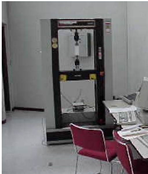
Figura V.3 Máquina Instron utilizada en las pruebas de Fractura.
