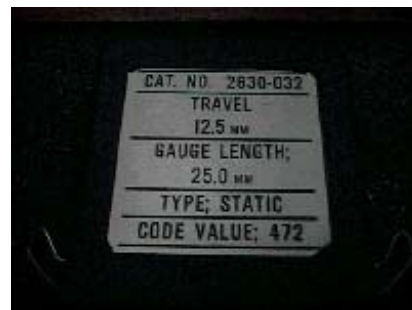
Fotografía A-11 Módulo o terminal del extensómetro.
