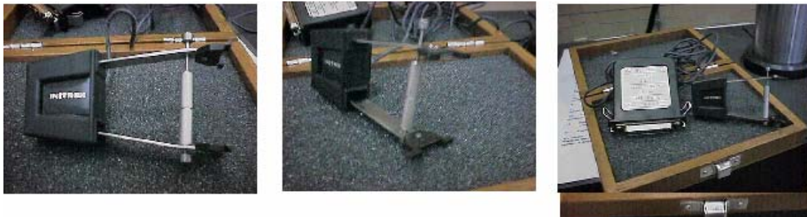
Fotografías A-8, A-9 y A-10 Extensómetro con aditamentos empleado para la prueba de tensión
