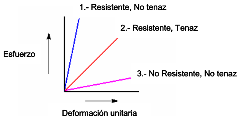
Fig. 1.5 Curva Esfuerzo – Deformación unitaria para distintas clases de plásticos [1.3]
