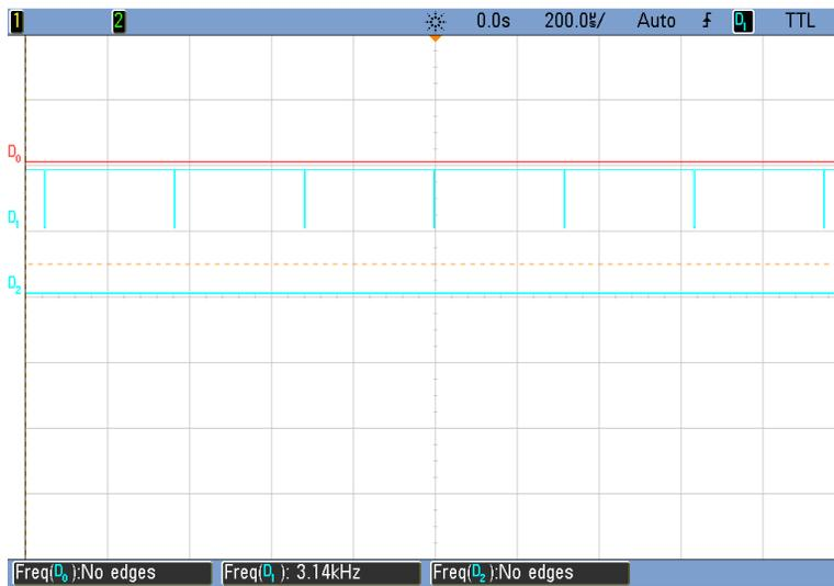
Figura 4.18. Señal del color verde a una frecuencia de 3.1 kHz con un ciclo de trabajo al 100%.
