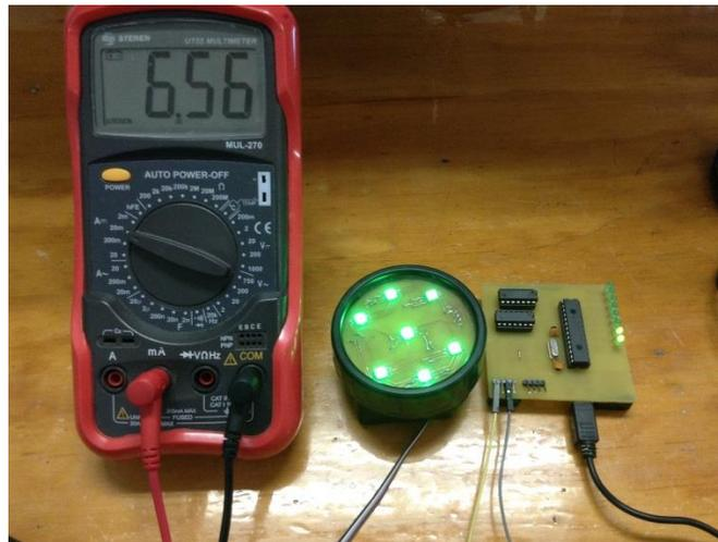
Figura 4.11. Medición de Corriente del LED verde.
