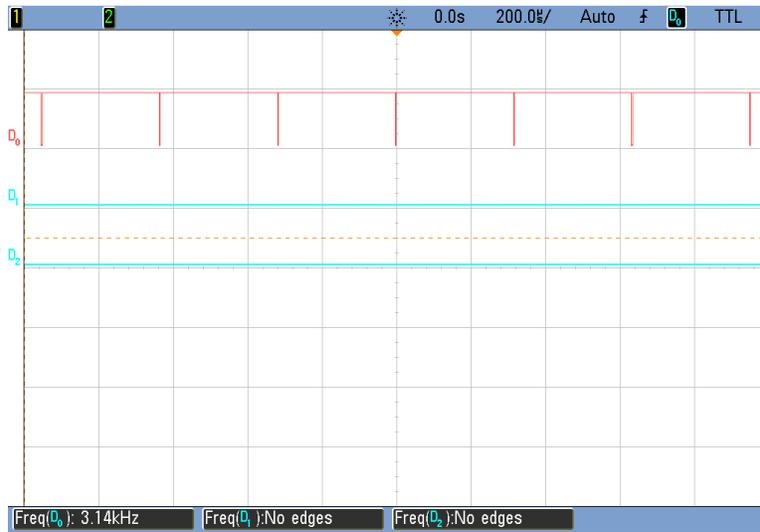
Figura 4.17. Señal del color rojo a una frecuencia de 3.1 kHz con un ciclo de trabajo al 100%.
