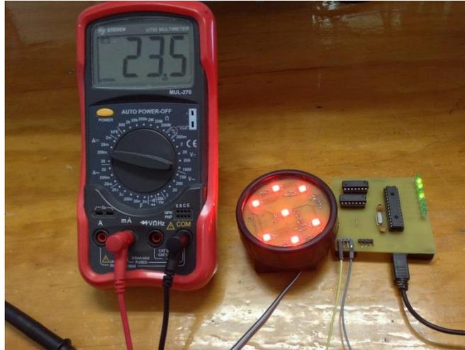
Figura 4.10. Medición de Corriente del LED rojo.
