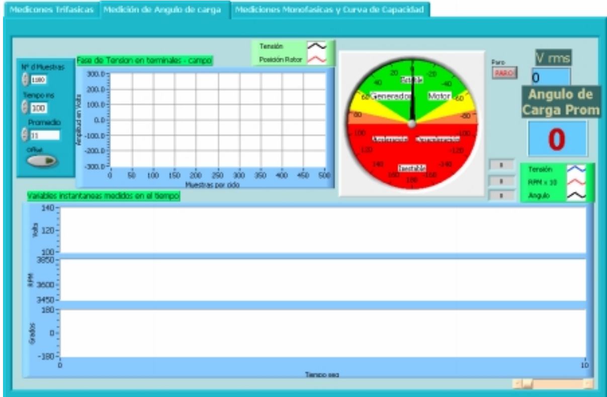
Figura 3.11 Panel Frontal - Menú principal, opción Mediciones del ángulo de carga
