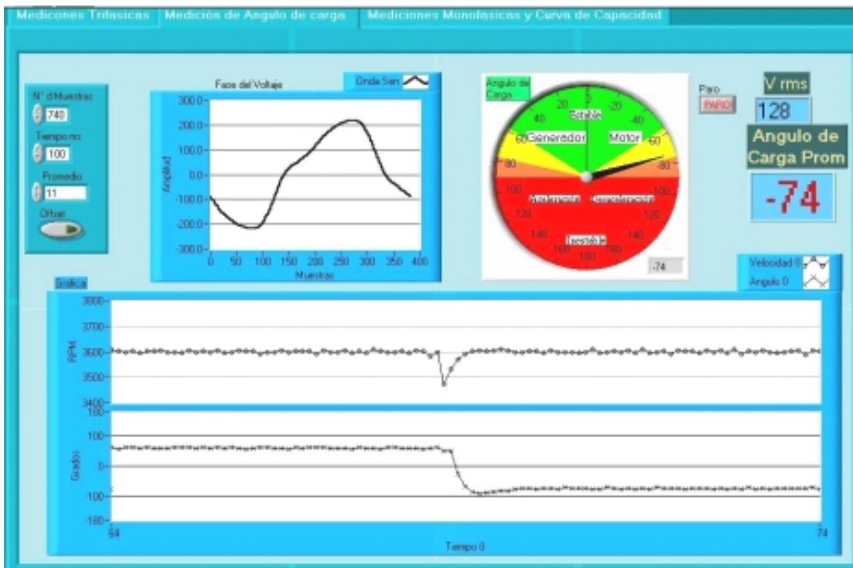
Figura 4.10 Medición del ángulo de carga de Generador a Motor Síncrono
